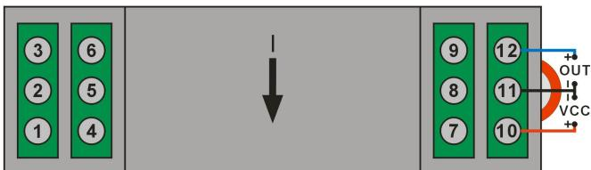
注: 电流穿孔输入; 11、12 位端子为输出端子; 10、11 端子为电源端子。11 位端子为输出地与电源地共地端; 1-9 位端子为空脚, 无须接线。
