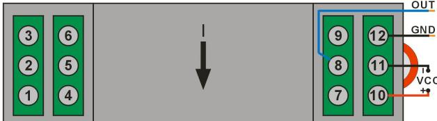
注: 电流穿孔输入: 8、12 位端子为输出端子; 10、11 端子为电源端子。输出地与电源地共地端; 1-7、9 位端子为空脚, 无须接线。
